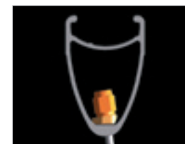
Système écrou-plaquette auto-orientant pour une distribution optimale des charges
