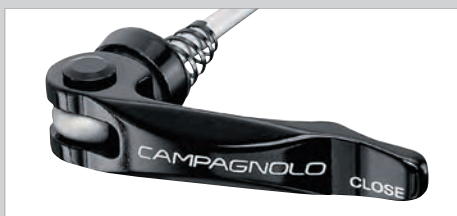
CLAVIJA Y EXCÉNTRICO DE ACERO, PALANCA Y TUERCA DE ALUMINIO. El cierre con sistema excéntrico permite modular la fuerza necesaria para el accionamiento de la palanca y tener una mayor sensibilidad para encontrar el correcto cierre del bloqueo. Sencillez de utilización, material resistente al desgaste, a la corrosión y al esfuerzo.
