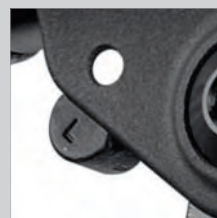
SISTEMA DE DESENGANCHE RÁPIDO: facilita el montaje y el desmontaje de la rueda y permite, incluso durante la carrera, ampliar la distancia entre la llanta y las zapatas de freno.
